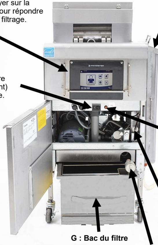
**E : Récipient d'huile :** Contient l'huile pour le système d'appoint automatique. Il n'est pas utilisé pour remplir les bacs de cuisson, seulement pour maintenir le niveau d'huile. Utiliser seulement de l'huile fraîche dans le système d'appoint.
